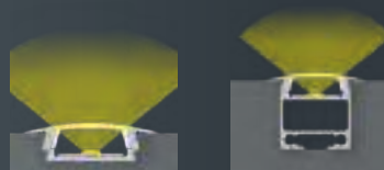
Encastrement Encastrement avec goulotte de câblage universel
